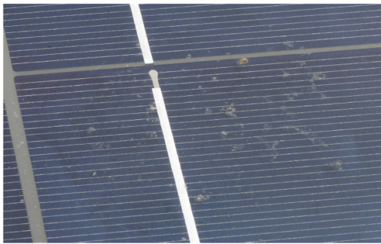
Fig.8 Immagine reale di un deposito meno consistente sulla superficie del pannello fotovoltaico.
