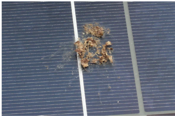
Fig.2 Immagine reale del deposito sulla superficie del pannello.
